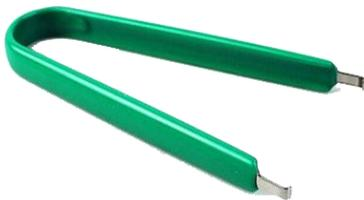
**DIP 封装集成电路起拔器：**用于将双列直插封装的集成电路从面包板上取下，同时不损伤器件。使用时，将起拔器的两个爪，插入到集成电路的两侧，然后握紧夹子，轻轻上提将集成电路拔出。无该工具时，可用镊子代替将镊子插入面包板的中间槽中，在集成电路的两头来回轻轻地往上撬，切不可仅在一头用力撬，那样容易将集成电路的引脚折弯。
