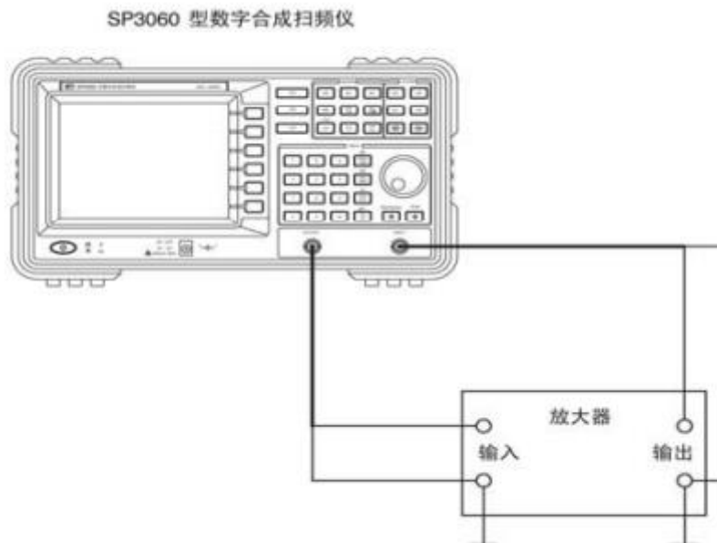
图 1.6 利用扫频仪测量放大电路频率特性
