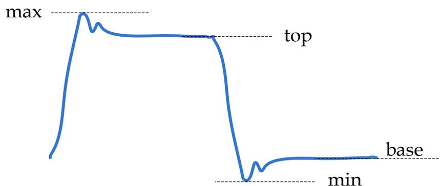
图4 示波器有关电压参数的定义
