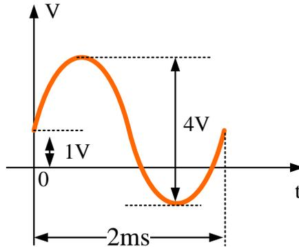
图 5 叠加在直流上的正弦波
