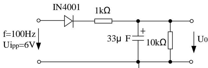
思考：查阅资料，理解纹波的概念。测量纹波时示波器的输入耦合方式拨在什么位置？DC 可以吗？
