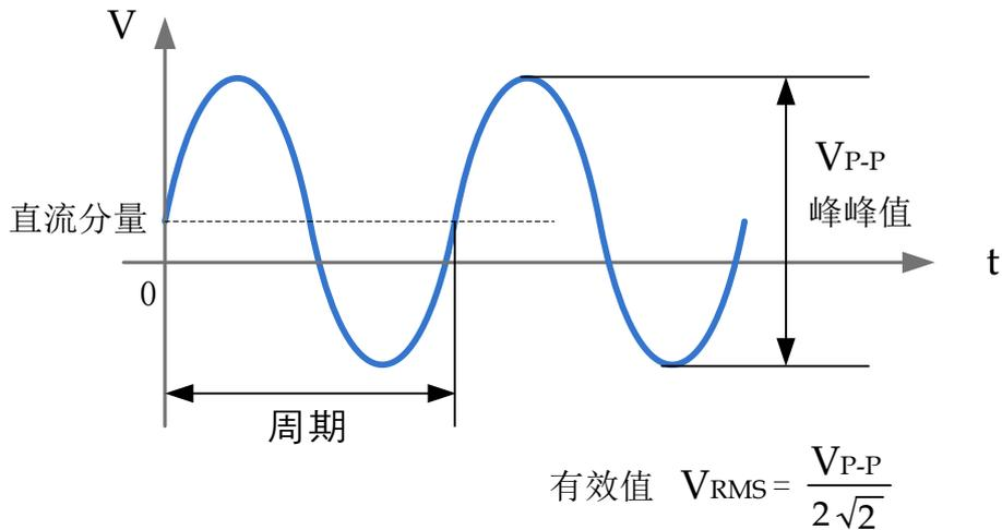
图 1 正弦波信号参数定义
