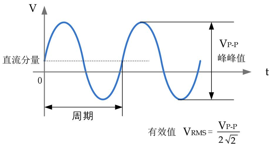
图 2 正弦波信号参数定义
