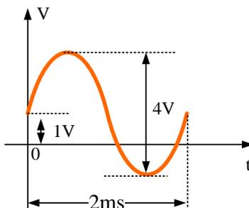
图 4 叠加在直流上的正弦波
