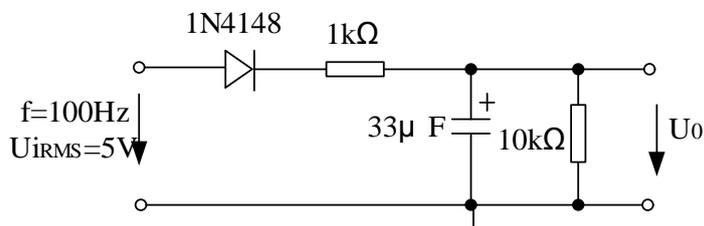
图 6 半波整流电路测量纹波电压
