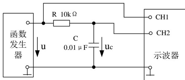
图 5 RC 串联电路
