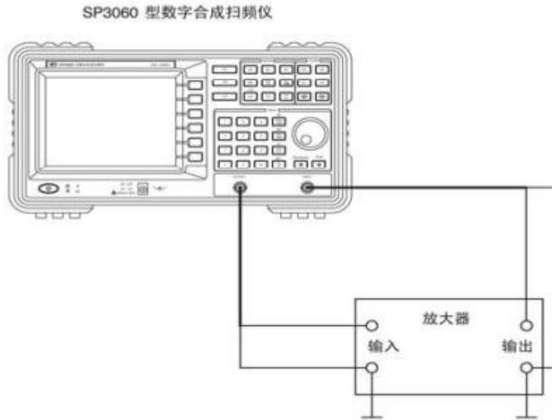
图 2.7 利用扫频仪测量放大电路频率特性
