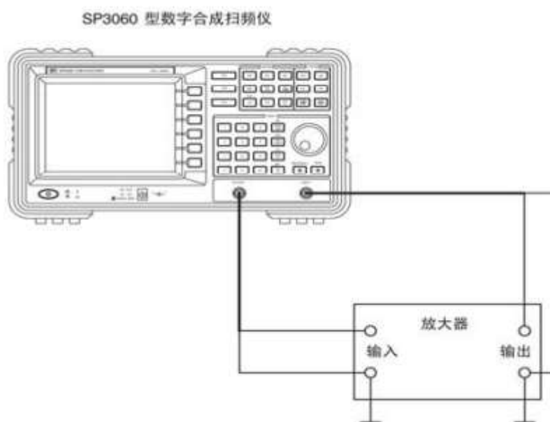
图 6 利用扫频仪测量放大电路频率特性
