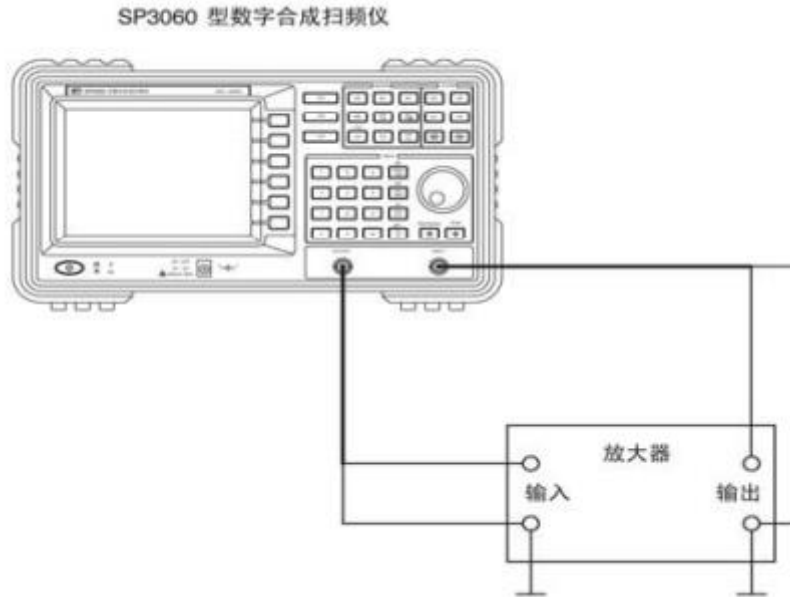
图 1.6 利用扫频仪测量放大电路频率特性
