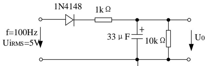
图 4 半波整流电路测量纹波电压
