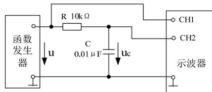
图 3 RC 串联电路
