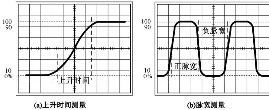
图 1 示波器测量脉冲信号
