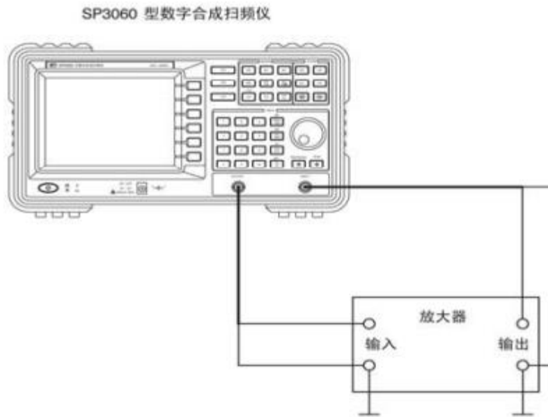
图 2.6 利用扫频仪测量放大电路频率特性
