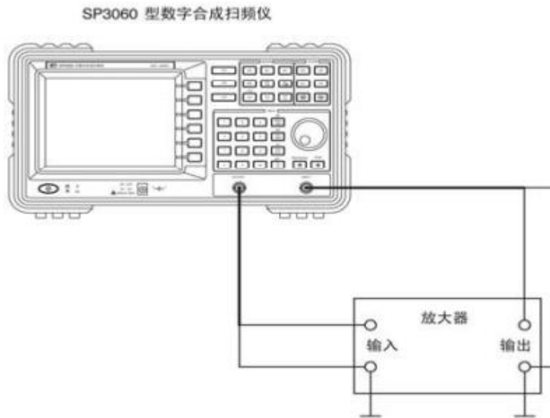
图 1.6 利用扫频仪测量放大电路频率特性
