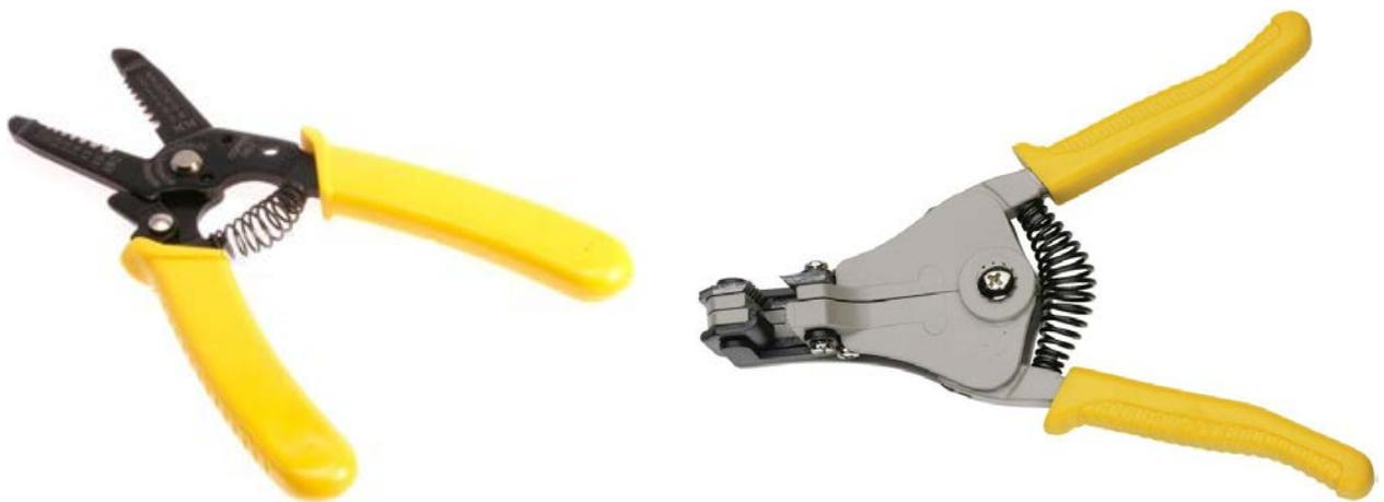
**剥线钳：**用于剥除电线头部的表面绝缘层，常用的剥线钳有两种，如上图所示，两种功能基本相同，任选一种即可。剥线钳使用时要掌握以下要点：
