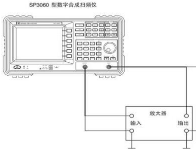
图 1.6 利用扫频仪测量放大电路频率特性
