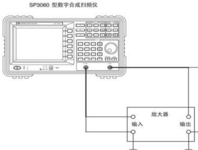
图 1.6 利用扫频仪测量放大电路频率特性
