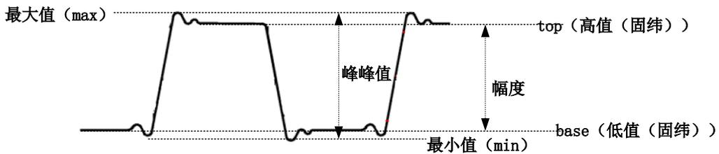
图 10 示波器有关电压参数的定义
