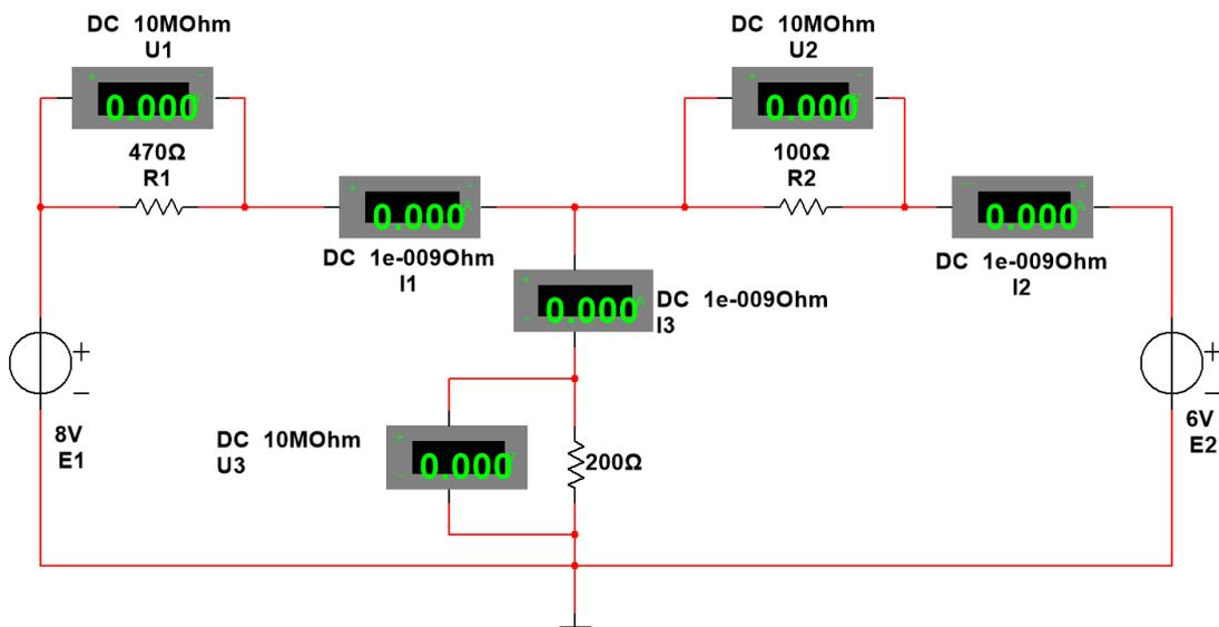
图 6 电压表电流表的连接
