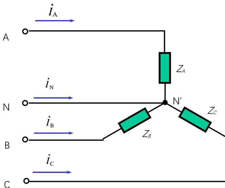
图 5 负载星形联结的电路
