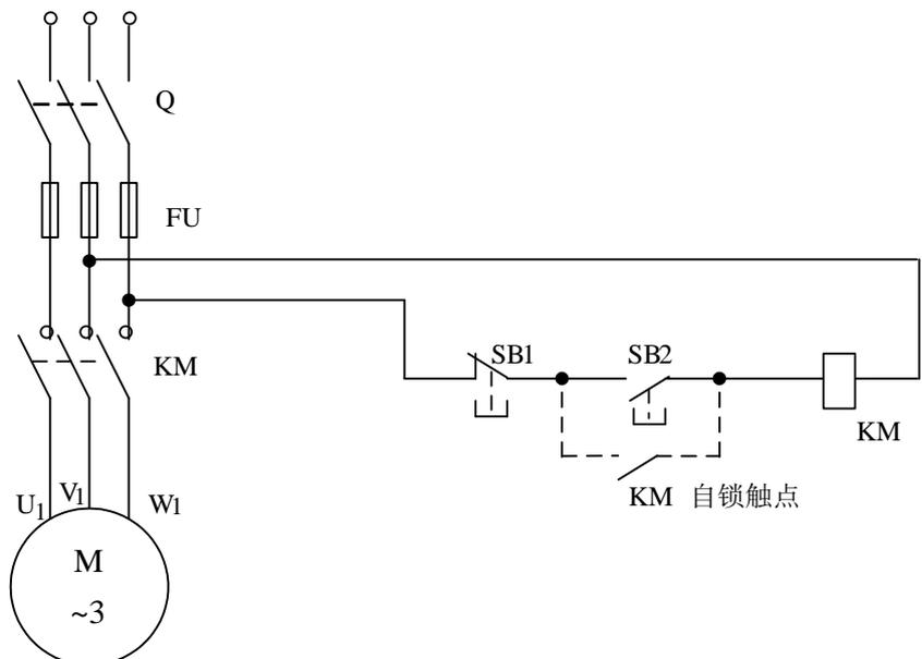
图 8 三相异步电动机的启动、停止控制
