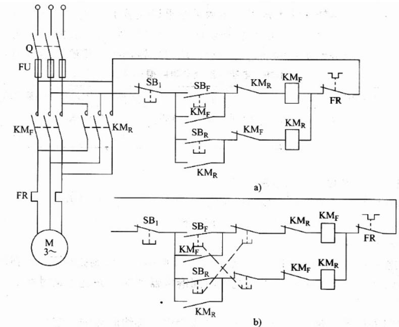
图 9 三相异步电动机的正反转控制电路
