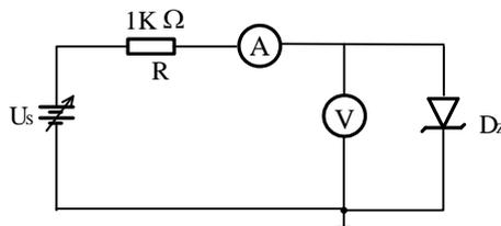
图 2 测量稳压二极管的伏安特性
