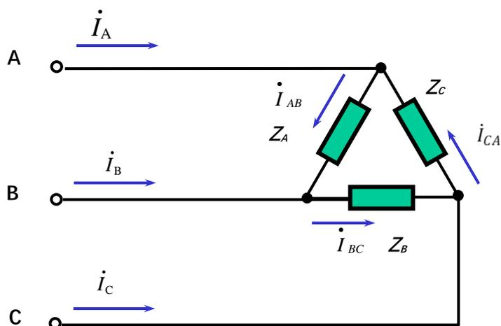
图 6 负载三角形联结电路
