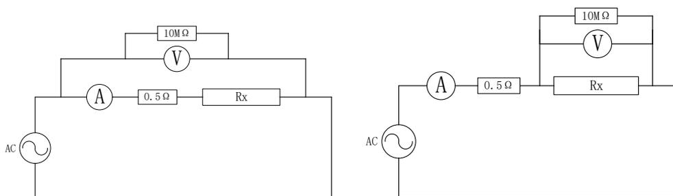
图 8 电流表内接法、电流表外接法
