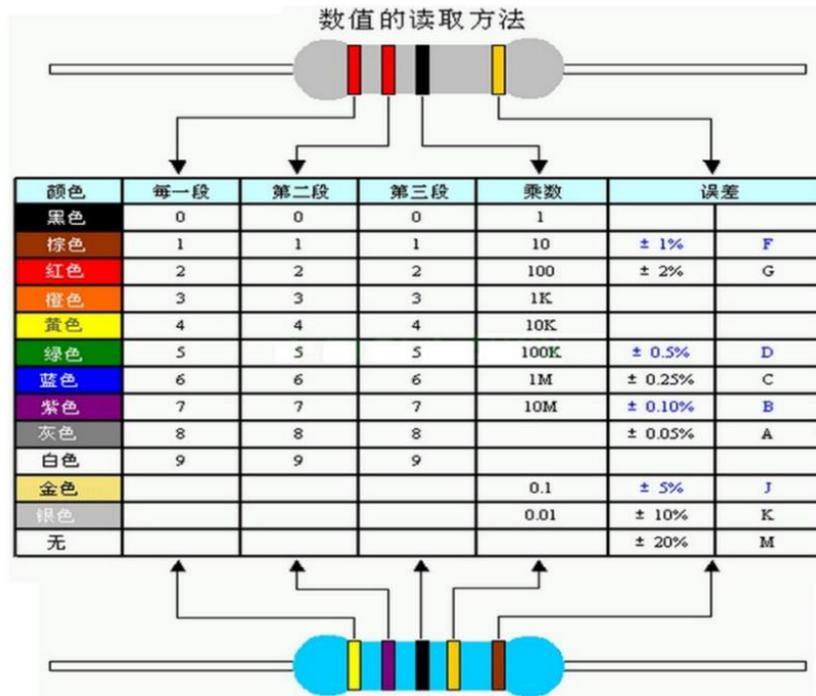
图5 四环电阻、五环电阻参数读取方法
