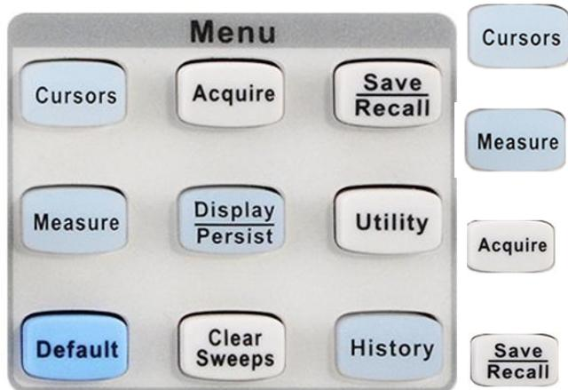
按下该键直接开启光标模式。示波器提供手动和追踪两种光标模式，另外还有电压和时间两种光标测量类型。
