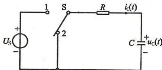
图 1 零状态响应和零输入响应
