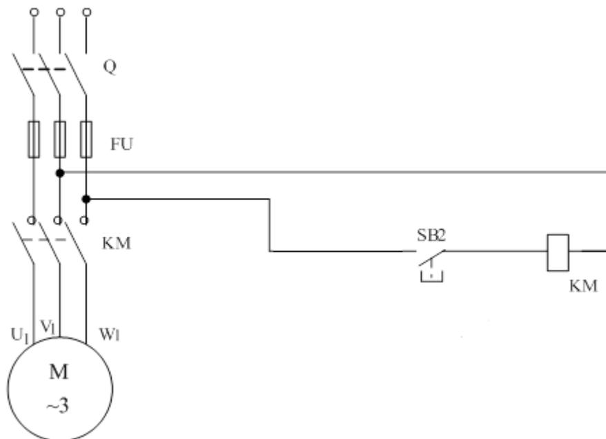
图 7 三相异步电动机的点动控制电路
