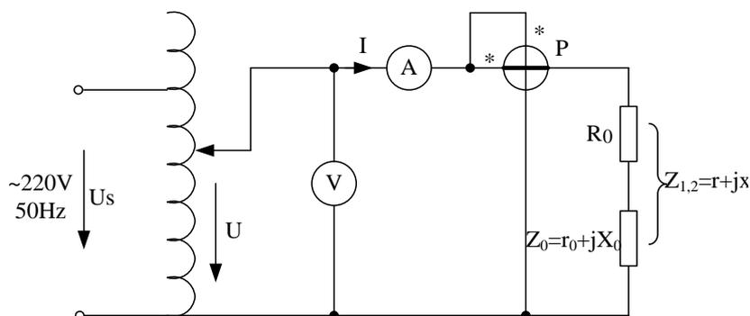
图 2 三表法测量电路
