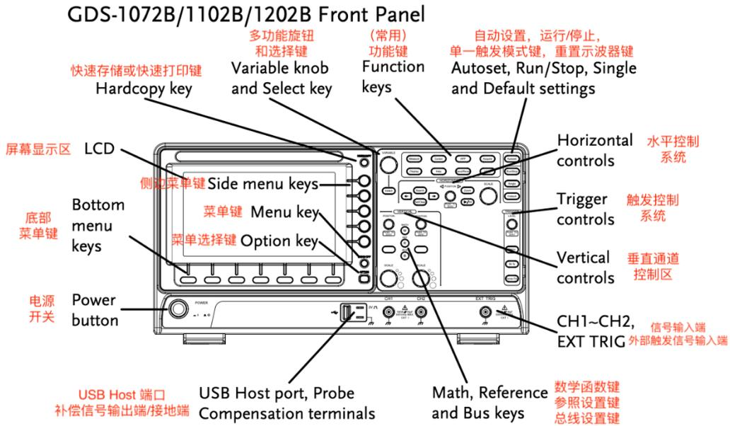
图 9 固纬示波器前面板
