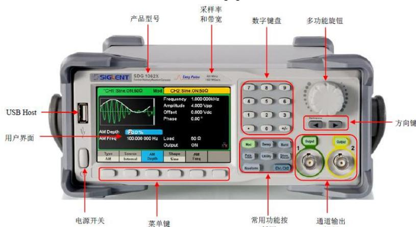
图 2 DDS 信号源面板
