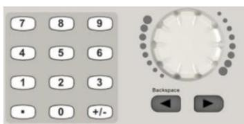
**数字键盘**: 用于编辑波形时参数值的设置, 直接键入数值可改变参数数值。
